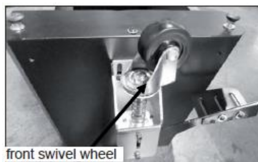
support bracket fixing screw - Extension optionnelle du kit de mobilité front mobility wheel, spring-fitted - Ressort de la roue avant front swivel wheel - Roue avant
