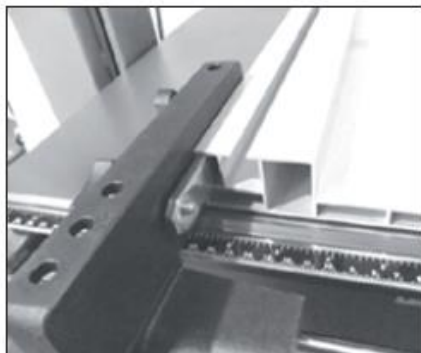
Guide à refendre en position horizontale
